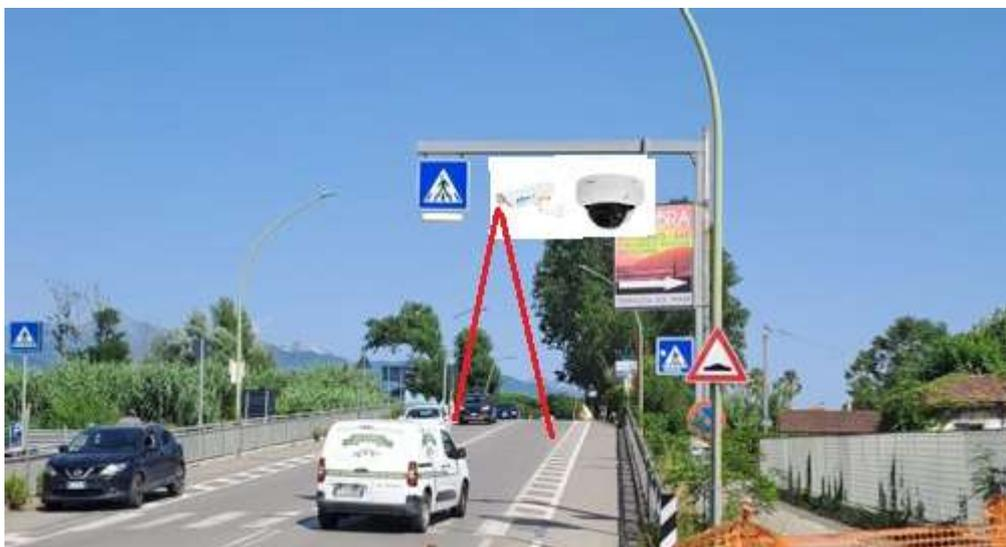
Il preventivo prevede installazione di camera e quadro sul montante della cartellonistica. In alternativa sarà installato un palo su un plinto situato sull'isola di traffico. Il sistema di ricarica sarà collegato ai cavi di alimentazione preesistente. In seguito, sarà installato le telecamere di lettura targhe e telecamera dome di contesto.
